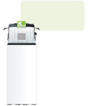
Der Abbiegeassistent für den Frontbereich überwacht den Bereich der vorderen rechten Ecke des Fahrzeuges im Abstand von 10 Meter frontal und 3 Meter seitlich.
